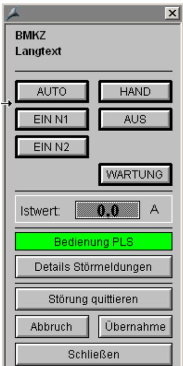
Bild: Bedienfenster Antrieb zwei Drehzahlen
