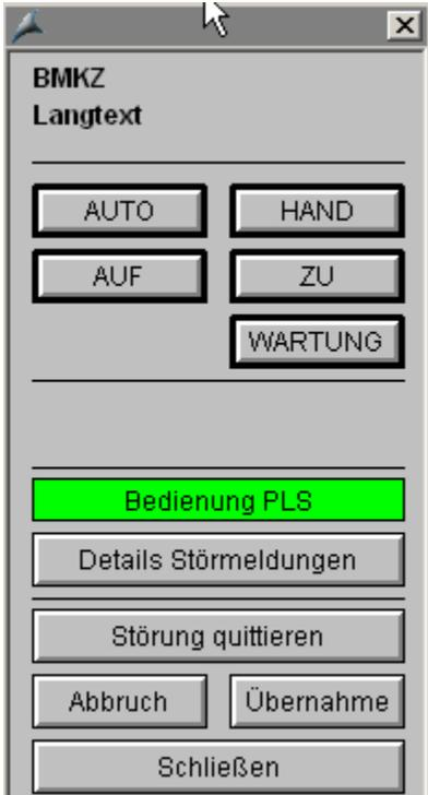
Bild: Bedienfenster Magnetventil
