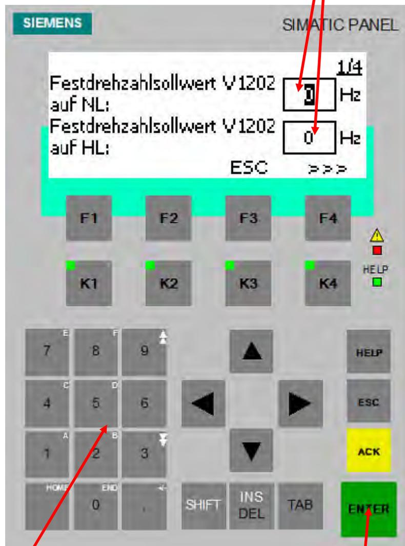
Die Eingabe der Sollwertvorgabe erfolgt dabei über die Numerische Tastatur am OP und wird mit der Bestätigungstaste Enter, abgeschlossen.
