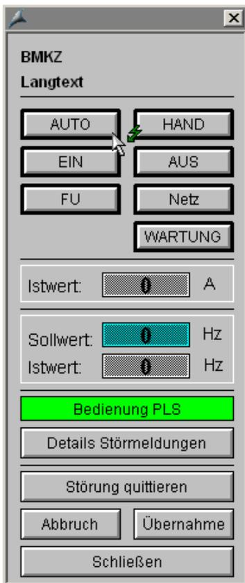
Bild: Bedienfenster Antriebe mit Frequenzumrichter
