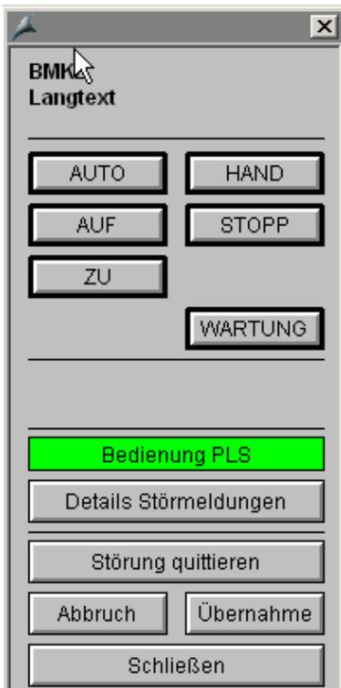
Bild: Bedienfenster Schieber- Standard- Stellantrieb
