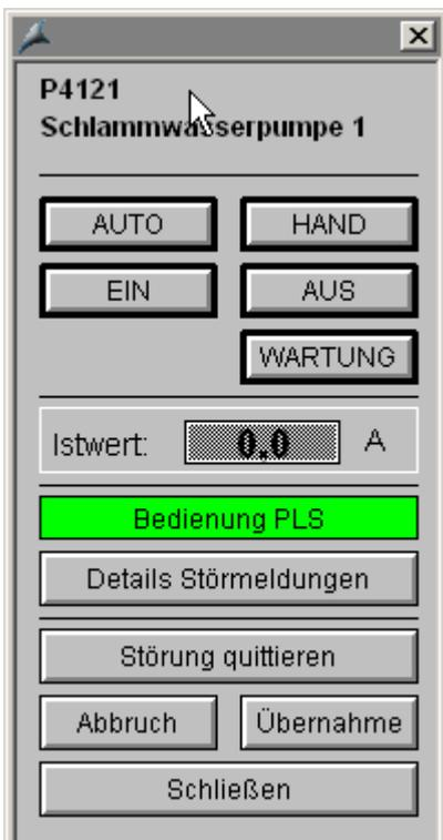
Bild: Bedienfenster Antrieb eine Drehzahl
