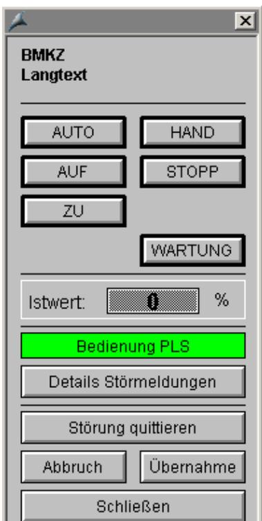
Bild: Bedienfenster Schieber- Standard- Regelantrieb
